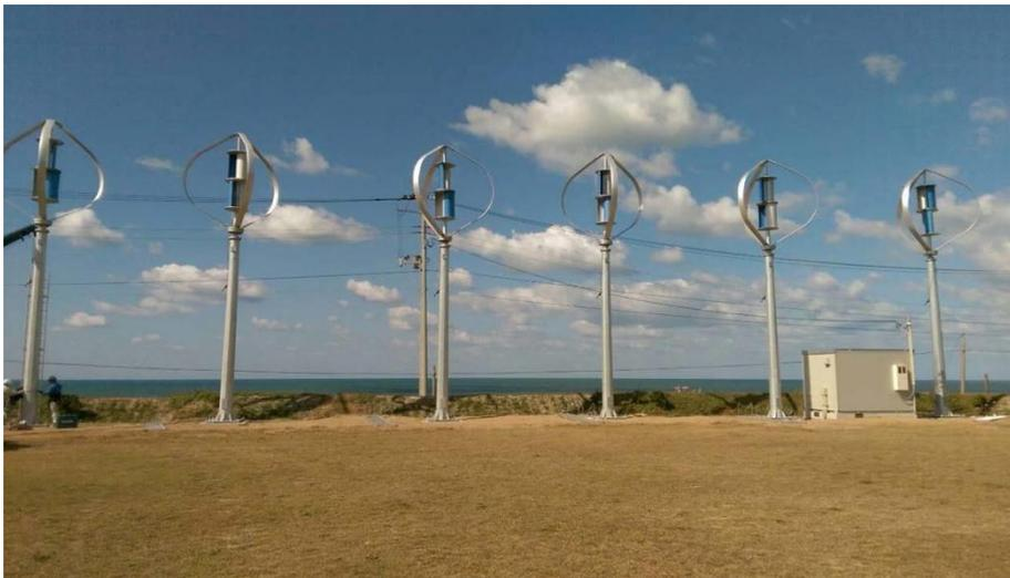
Generatori eolici DS3000 potenza in uscita 3kW a 12mt/s, dotato di sistema di protezione attivo a 17mt/s.
